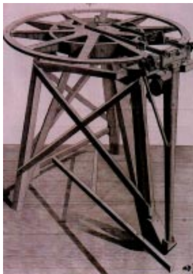
Fig. 2. Máquina de dividir circular inventada por Jesse Ramsden. Desenho incluído na sua obra Description of an engine for dividing mathematical instruments , Londres, 1787. Biblioteca Central de Marinha, Lisboa. Fotografia de Lama Castro e Paulo Cintra.
