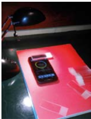
Figura 3. Montagem experimental mostrando o smartphone Android onde foi instalada a app gratuita Lux Meter.
