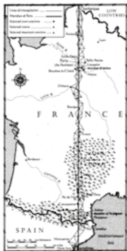
Figura 2. Medida da distância entre Dunkerque e Barcelona, ambas sobre o mesmo meridiano. Uma pausa em Paris para lembrar a origem do Sistema Métrico!
