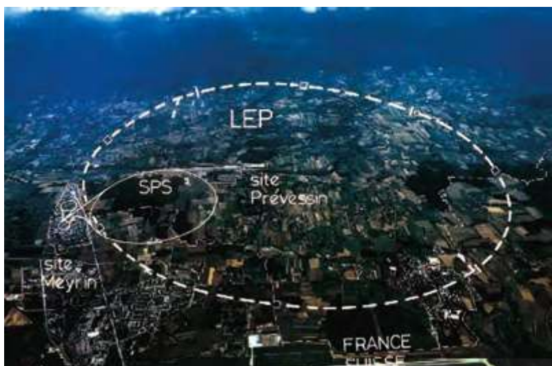
Figura 2. Grande colisor de elétrões e positrões, na fronteira franco-suíça. Numa direção, atiram-se elétrões a velocidades altíssimas; na direção contrária, voam suas antipartículas, os positrões. Do resultado das suas colisões, estudam-se as suas propriedades – e também as propriedades de outros constituintes da matéria. Fonte: http://scienceblogs.com/startswithabang/files/2011/05/lep-birdsview.gif
