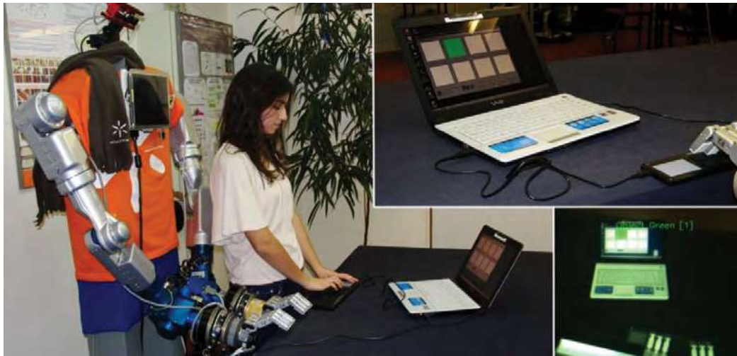
Figura 4. Configuração experimental: o robô AROS a aprender a tocar uma melodia num teclado.
