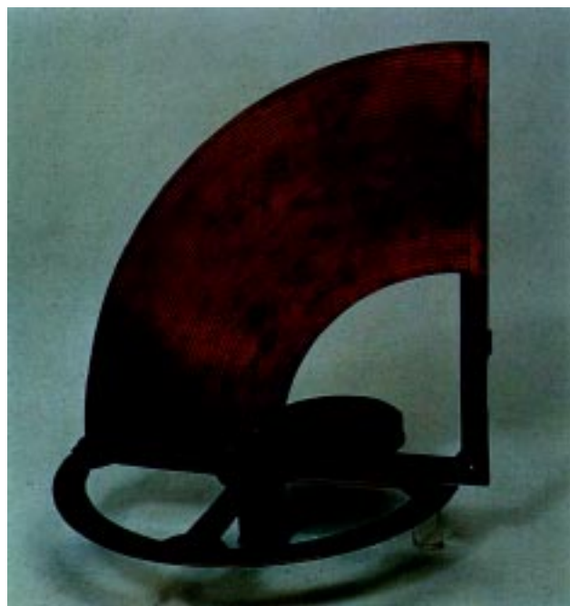
Fig. 12. Quadrante fabricado por James Kynuyn, em 1595, conforme indicado no catálogo do Instituto e Museu de História da Ciência de Florença. É possivelmente o único instrumento que existe dispondo do nóvio de Pedro Nunes.
