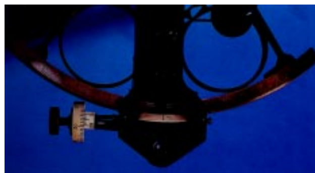
Fig. 15. Sistema de leitura rápida, incluído em sextante fabricado por Salmoiraghi, 1938. Sistema usado nos sextantes desde há pelo menos meio século e que permite a leitura de ângulos com a aproximação ao minuto de arco. Museu de Marinha, Lisboa.
